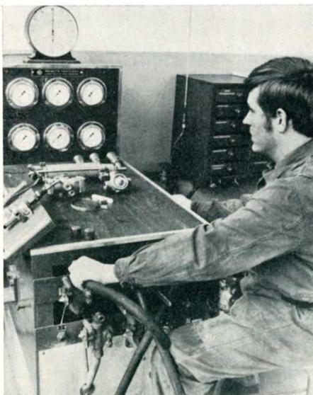
Die Bremsen sind beim Auto bestimmt so wichtig wie der Motor — ganz besonders beim Omnibus. Er befördert ja über 100 Personen. Auf eigenem Bremsprüfstand stehen die Anlagen der Omnibusse täglich unter Kontrolle.
