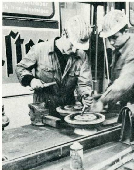
Verschleißreparaturen gehören zur Routine. Ob Kupplungsbeläge erneuert oder Bremsen nachgestellt werden müssen: Geschickte Hände und das richtige Werkzeug lassen jede Reparatur schnell erledigt sein.
