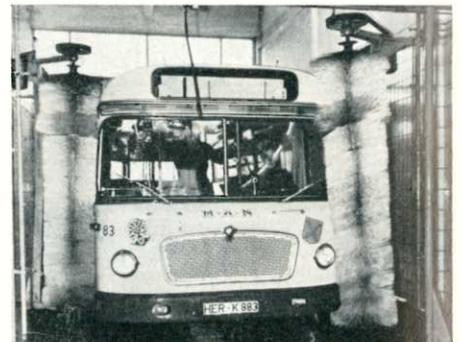
In der automatischen Waschanlage. — Rotierende Bürsten waschen den Lack. Schlauchschalter lassen das Wasser fließen.
